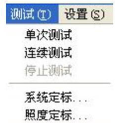
照度定标：需使用标准光源校准测试仪器光参数。
