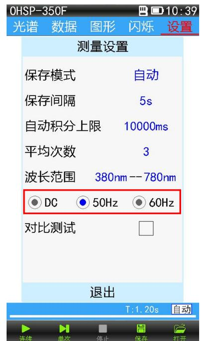
图 3 频率同步设置
