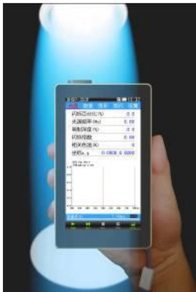
将光谱采样孔正对被测光源
